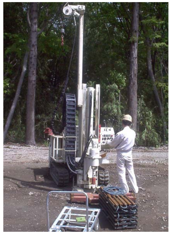
写真-1.2 CPT（電気式静的コーン貫入試験）
