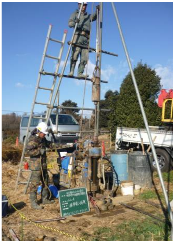
写真-1.1 ボーリング（標準貫入試験）
